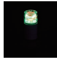
緑色LEDが点灯+赤色LEDが回転動作とブザーの鳴動 サーキットプロテクターの2つともトリップした状態
