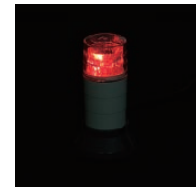
赤色LEDが回転動作とブザーの鳴動 サーキットプロテクターの2つともトリップした状態
