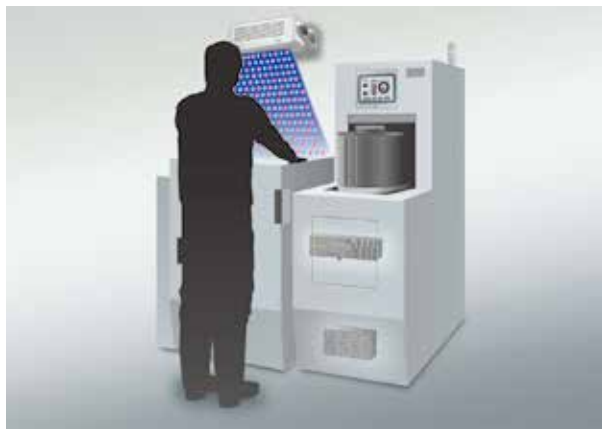
ICチップ実装検査時の除電により 静電気破壊や異物付着を防止
