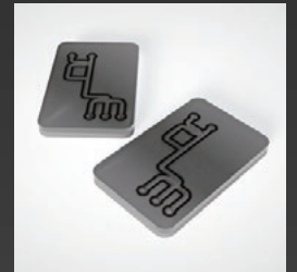
マイクロ流体デバイス：流路の溶着
