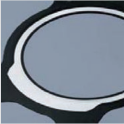
ガスケットの表面剥離
