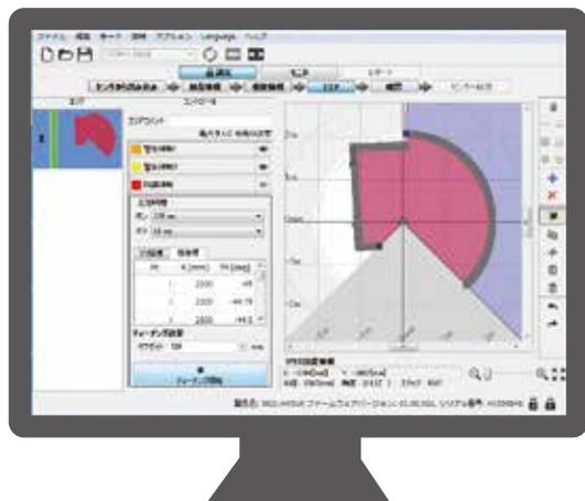
ティーチング機能により、壁や柱などの障害物を参照して自動的に防護エリアを設定できます。複雑な背景でもこの機能を利用すれば最小限の手間でエリアを描画できます。
