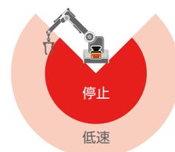
SE2L形は接近を検知できるセーフティセンサです。追加の防護エリアで接近を検知して減速を開始させれば、停止エリアを小さくできます。(\*2)
