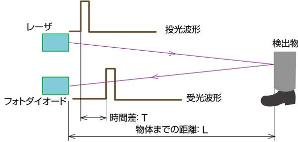
パルスレーザ光の投光から反射光の受光までの時間差を用いて、以下のように距離の計算が行われます。
