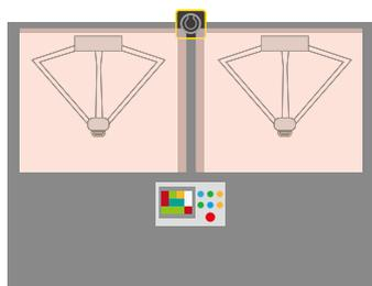
2つの危険区域への侵入を別々に監視し、機械を停止させることができます。反射形センサなどで面倒な光軸合わせが不要な上、ライトカーテン2台分を1台で兼ねることができます。
