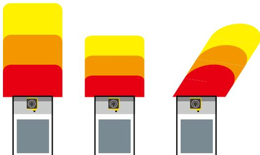
無人搬送車（AGV）などで、周囲環境に合わせて最大128\*種類の防護エリアを設定・切替できるため、多彩な環境で最適な防護を実現します。
