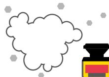
空気中にあるホコリや塵を信号から判断し、意図しない検出を低減します。安全機能は損いません。また、警報機能により光学窓の汚れエラーでOSSDがOFFになる前にお知らせします。
