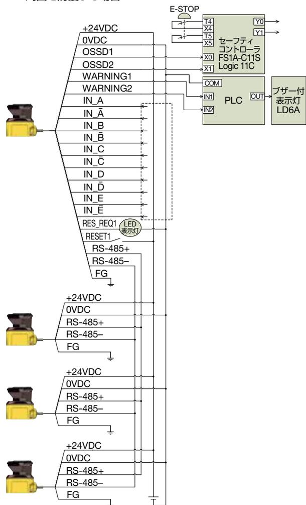
e) マスタースレーブ機能により複数の危険源を防護し、部分停止させる場合
