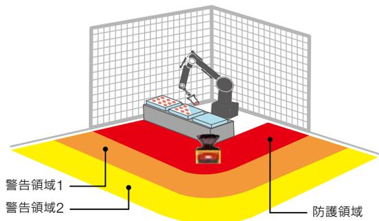
警告領域1/2は停止の前に警報などを発信するための検知領域で、防護領域の外側を取り囲むように設定します。
