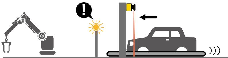
ミュート機能を有しているため、防護領域の一部を無効化することでワークの搬入に対応し、生産性と安全性を両立させます。
