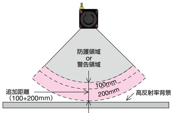
※ 追加距離=高反射率背景下でSE2L形を動作させるための追加距離
