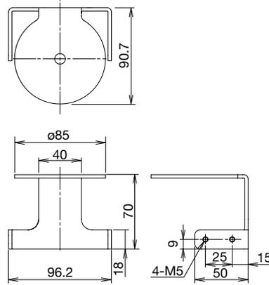
※ 底面取付金具、または背面取付金具と組み合わせて光学窓を保護します。なお、底面簡易取付金具および、背面簡易取付金具(ロングタイプ)には取付できません。
