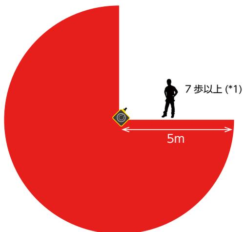
1台で広く（270度）長く（5m）安全防護できるため、ロボットを使う大形設備や長く続くコンベアラインなど幅広いシーンにご利用いただけます。
