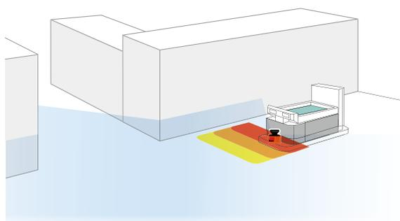
安全防護しながら距離測定データをEthernetポートから出力し、周囲環境の障害物情報を得ることができます。
