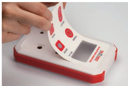
⑧ケースにシートを貼付け
