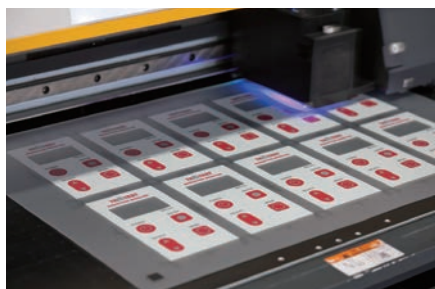
①シートにインクジェット印刷
