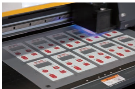
①シートにインクジェット印刷
